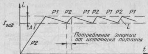
Рис. 5.13. Временная диаграмма поддержания тока с использованием режимов  $P_2, P_1$
