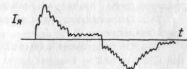
Рис. 8.34. Переходный процесс тока при пуске и реверсе
