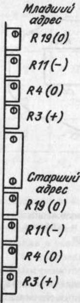
Рис. 7.39. Расположение потенциометров в субблоке ЦАП
