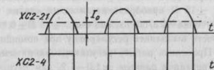
Рис. 1.44. Диаграмма настройки датчика нулевого тока
